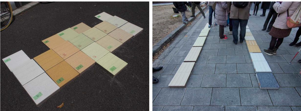
この結果選ばれた 4 種類の色のブロックに、比較のために濃い黄色と白のブロックを加えた合計 6 色のブロックを、路面に埋め込んで設置するブロックによく用いられるコンクリート、セラミック、タイルの 3 種類の材料で試作し、実際に路面に埋め込んで設置しました。
